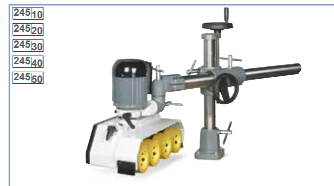
Vorschubapparat PV 84 Art.Nr. 4029 - 4 Rollen 120 x 60 mm - 8 Geschwindigkeiten (2/4/5,5/6,7/11/13/16,5/33 m/min) - Stativ mit verlängertem Auslegerarm 1050 mm - Rechts- und Linkslauf - Individuell horizontal und vertikal einsetzbar - Individuell einstellbar
