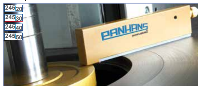
245|20 245|30 245|40 245|50 Zeromaster-Referenzmaßstellgerät, sorgt für kurze Rüstzeiten bei der Werkzeugkalibrierung Art.Nr. 2205
