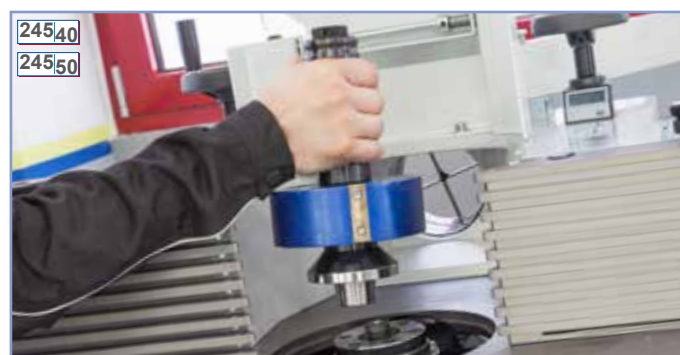
Fräsdorn-Wechselsystem HSK-63 F Art.Nr. 4286 Fräsdorn-Wechselsystem HSK-85 Power-Lock Art.Nr. 4287
