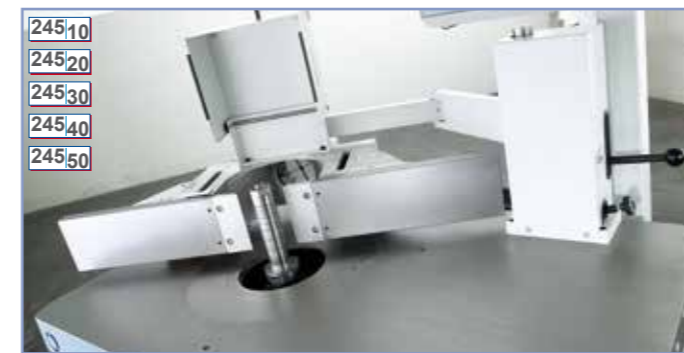
245|10 245|20 245|30 245|40 245|50 Wegschwenkvorrichtung handhydraulisch, komfortables und sicheres Anheben und Wegschwenken des Fräsanschlages Art.Nr. 4349
