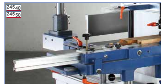
Rolltisch mit Anschlagaufnahme, Exzentrerspanner, Laufbahn einschiebbar, inkl. Schutzhaube 1641 Art.Nr. 4491
