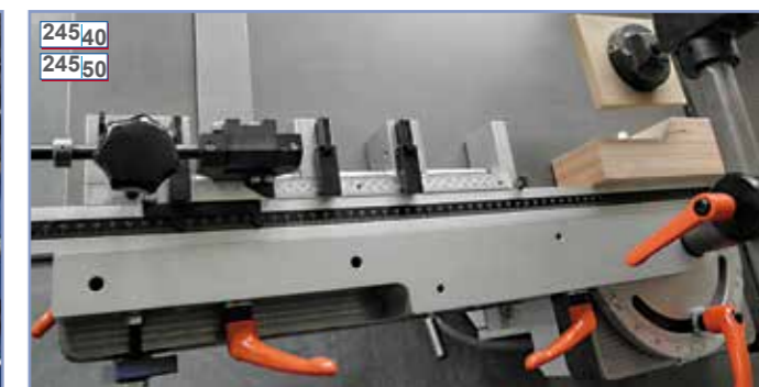
Längenanschlag LAS-M, 1750 mm lang Art.Nr. 4417 Verlängerung zu LAS-M, 2750 mm lang Art.Nr. 4418
