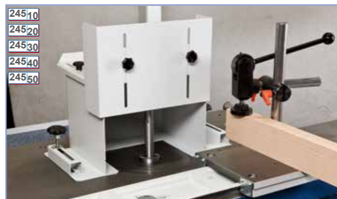
Schutzhaube 1641 für Zapfenschneid- und Schlitzscheiben bis max. 350 mm ø, aus starkem Stahlblech, mit verstellbarem Schutzdeckel, mit Absaugstutzen 120 mm ø
