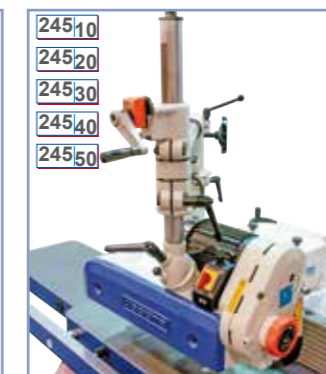
Vorschubapparat Variomatic 4N Art. Nr. 4638 - 4 Rollen (Rollenbreite geteilt 2 x 25 mm, Rollen ø 120 mm) - stufenlose Geschwindigkeit 2 - 18 m/min - Rechts-/Linkslauf - schnelles Drehen von horizontalem auf vertikalen Betrieb - einfaches Wegschwenken und Positionieren - Memory-Lock-System für wiederholgenaue Fixierung - Komfortstativ - numerische Höhenanzeige - Auslegerarm 1050 mm lang
