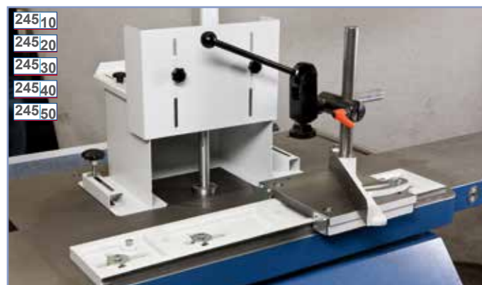
Zapfenschneid- und Schlitzapparat 1376 mit Exzenterspanner, mit einstellbarem Gehrungsanschlag 30° bis 150°. Schiebeshlitten läuft leicht auf Kugellagern.
