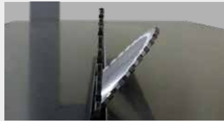
46° schwenkbares Sägeaggregat mit Vorritzfunktion
